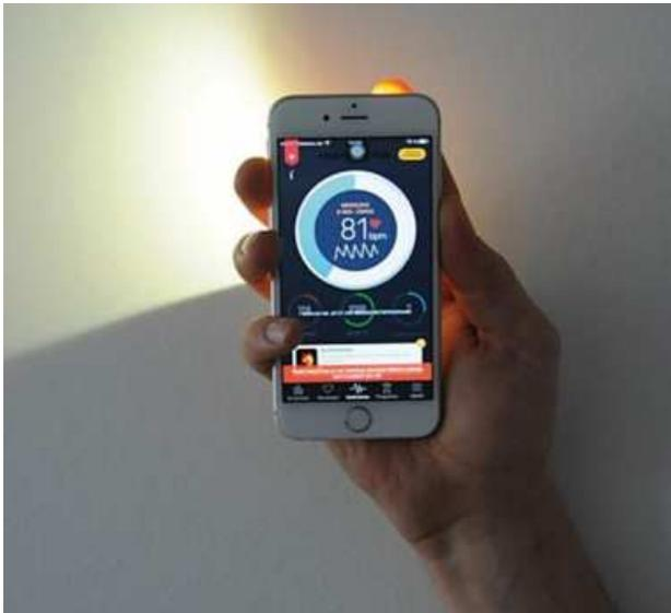
Links: Kapillarpulsanalyse mit Smartphone. Hier kann die Herzschlagfolge über eine Smartphone-App gemessen und gespeichert werden.
